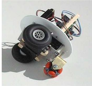
Figura 17: Rover 1: triciclo con ruote a guida differenziale e supporto su ruota omnidirezionale a  $90^\circ$ .
